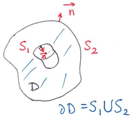
$$\iiint_D \nabla \cdot \vec{F} dV = \iint_{\partial D} (\vec{F} \cdot \vec{n}) dS = \iint_{S_2} (\vec{F} \cdot \vec{n}) dS + \iint_{S_1} (\vec{F} \cdot \vec{n}) dS$$
